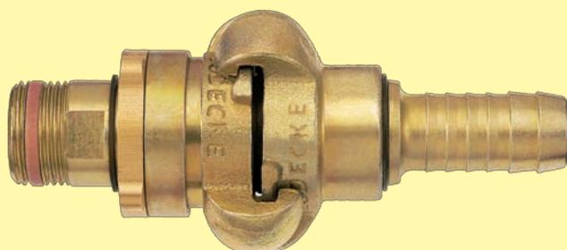
Wir empfehlen, immer einerseits eine Standard-Kupplung nach DIN 3489 und auf der Gegenseite eine MODY-Schraubkupplung nach DIN 3238 zu verwenden. Diese Verbindung ist absolut sicher, leicht zu kuppeln und 100 % dicht. Achten Sie auch auf die Verwendung von Klemmen nach DIN 20039 zur sicheren Schlaucheinbindung.
